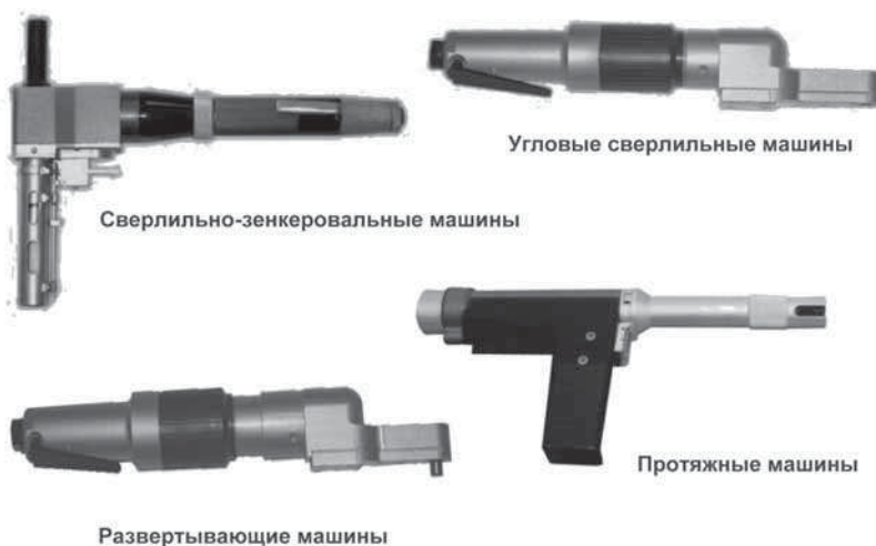
Рис. 6. Механизированный инструмент для обработки отверстий под крепежные элементы
