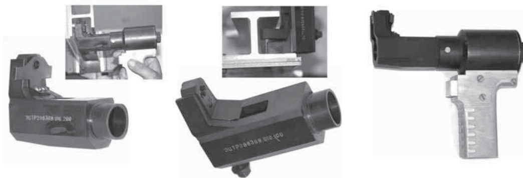
Рис. 7. Экспериментальные устройства, моделирующие исполнительные механизмы инструмента для выполнения БЗС группы В
