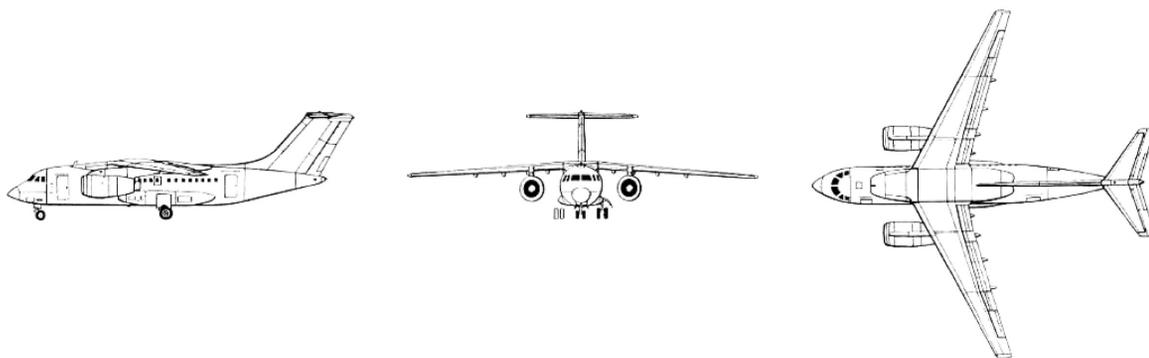
Рис. 14. Схема самолёта-высокоплана с двумя реактивными двигателями, расположенными на пилонах под крылом, и Т-образным оперением
