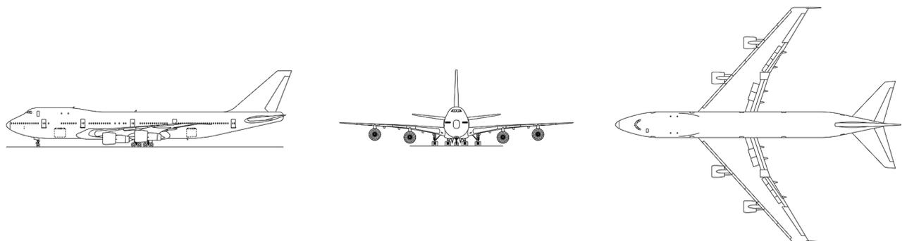
**Рис. 10.** Схема самолёта с четырьмя реактивными двигателями, расположенными на пилонах под крылом
