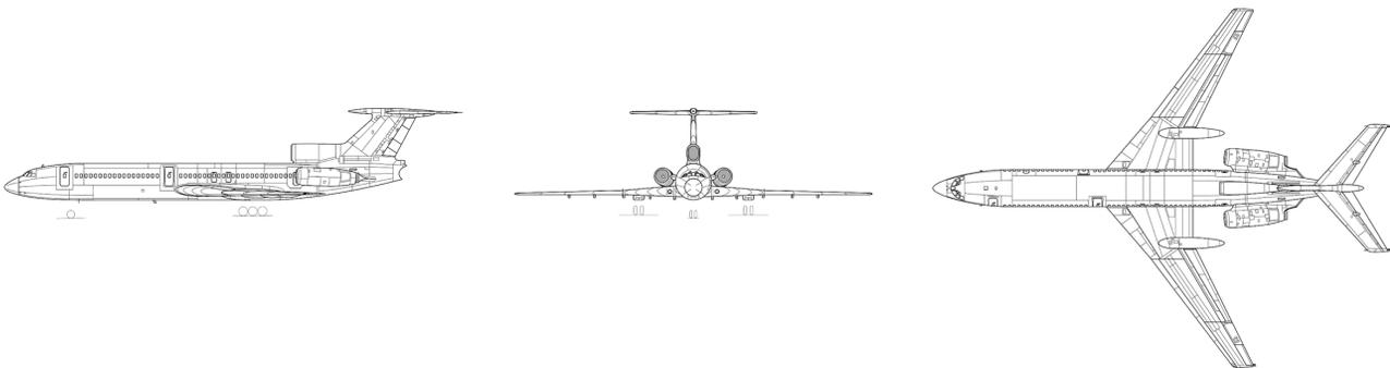
Рис. 6. Схема самолёта с тремя реактивными двигателями, расположенными в хвостовой части фюзеляжа
