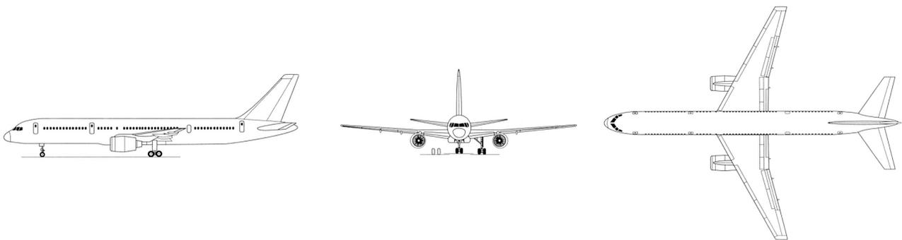
Рис. 5. Схема самолёта с двумя реактивными двигателями, расположенными на пилонах под крылом
