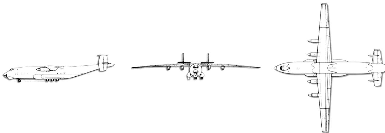
Рис. 2. Схема самолёта с четырьмя ТВД, расположенными на крыле
