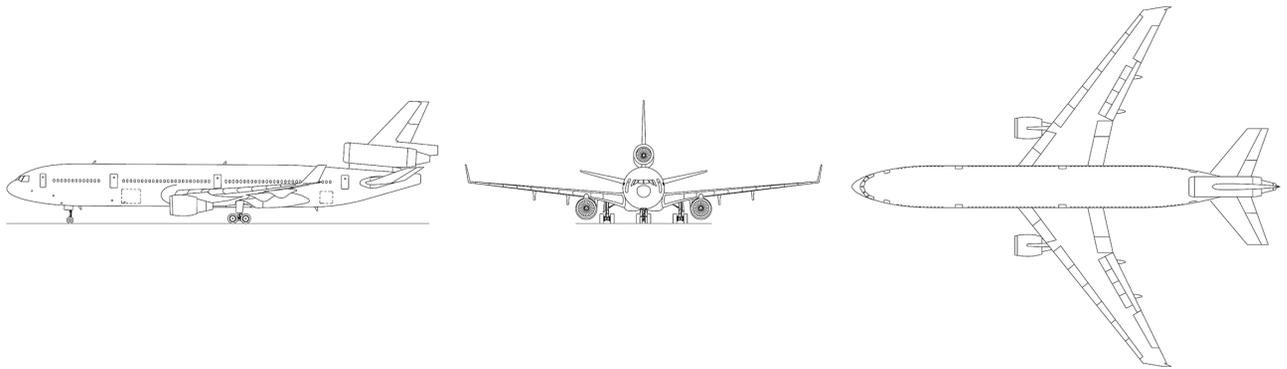
**Рис. 7.** Схема самолёта с тремя реактивными двигателями, два из которых расположены на пилонах под крылом, а третий размещён в хвостовой части фюзеляжа в корне киля
