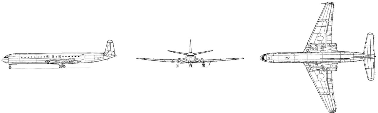
**Рис. 8.** Схема самолёта с четырьмя реактивными двигателями, расположенными в корне крыла по бокам фюзеляжа попарно
