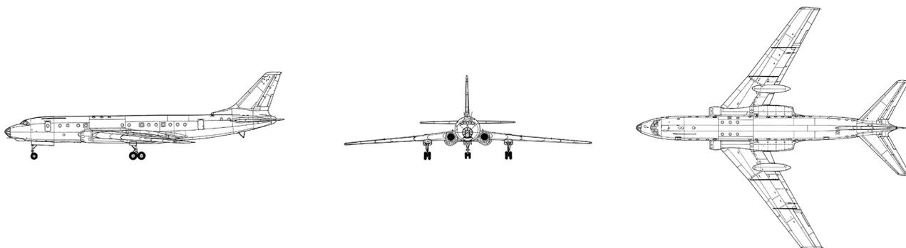
Рис. 3. Схема самолёта с двумя реактивными двигателями, расположенными в корне крыла
