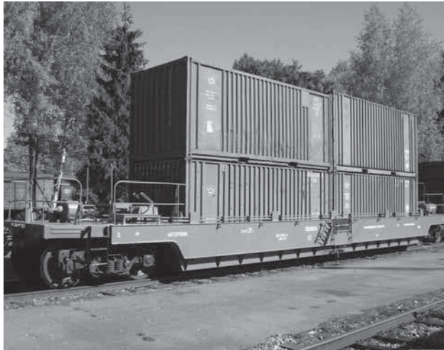
Рис. 1. Загальний вид вагона-платформи для перевезення великотоннажних контейнерів в два яруси
