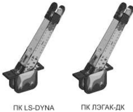
Рис. 11. Интенсивность напряжений в элементах силовой конструкции ЛА. Расчет ПК ЛЭГАК-ДК и ПК LS-DYNA. Результаты расчетов идентичны
