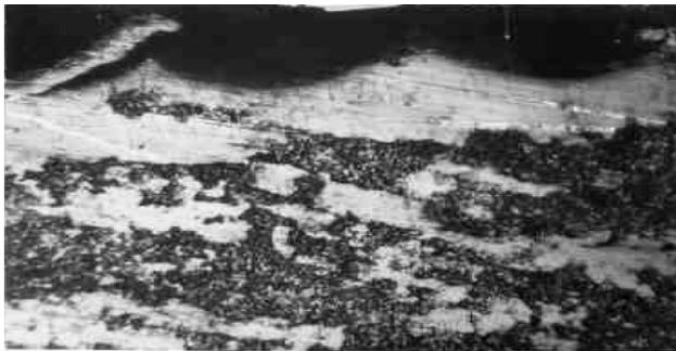
Рис. 4. Фрагмент поверхности детали после чистовой токарной расточки с микрозаусенцами. Увеличение 240
